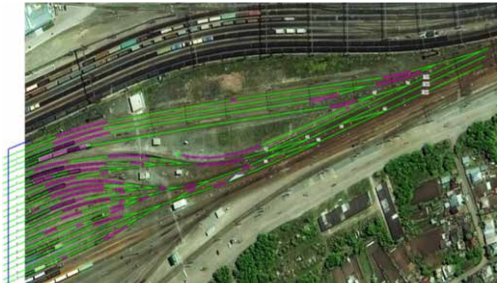
Рис. 2 Вариант удлинения сортировочных путей, выполненный в САПР «Компас-3D»
